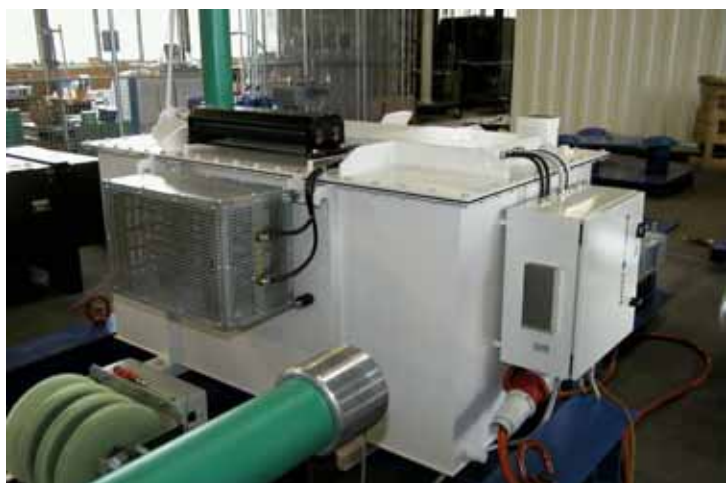
Charging rectifier 200 kV, 60 mA
